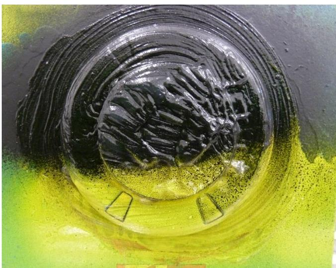
Schritt 1. Den Graffiti-Entferner mit einem weichen Pinsel auf die Oberfläche des zu testenden Bauteils auftragen.
